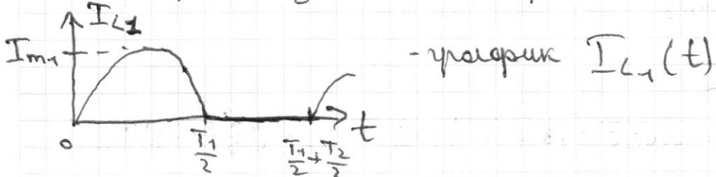
$$\text{Период} T = \frac{T_1}{2} + \frac{T_2}{2} = \pi \sqrt{7LC} + \pi \sqrt{3LC} = \pi \sqrt{LC} (\sqrt{3} + \sqrt{7})$$
