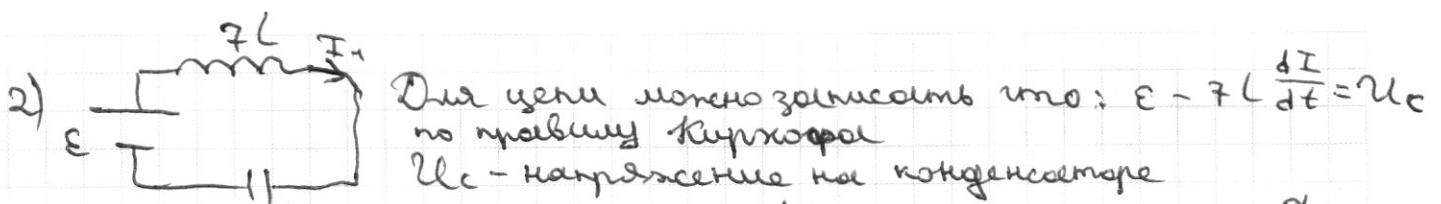
$$\text{Поток } I_1 \text{ максимален, когда } \frac{dI}{dt} = 0 \Rightarrow \epsilon = U_C = \frac{q}{C}$$
