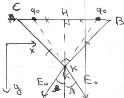
Несимметричный заряд на пластине BC не создает напряженности в м.к. т.к. заряды на пластине BC не создают напряженность на Ox.
