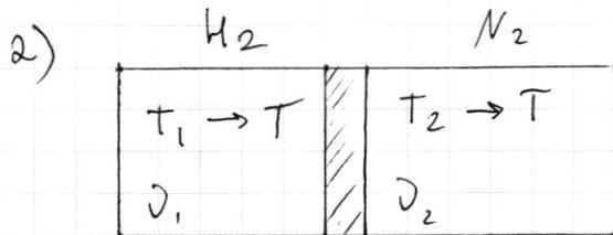
Система теплоизолирована, но поршень проводящий  $\Rightarrow$   $N_2$  будет передавать тепло  $H_2$  за счёт разности темпера-
