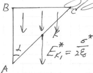
Найдём  $E_{K2}^*$ , когда обе пластинки заряжены и имеют поверхностную плотность заряда  $\sigma^*$ , используя принцип суперпозиции:
