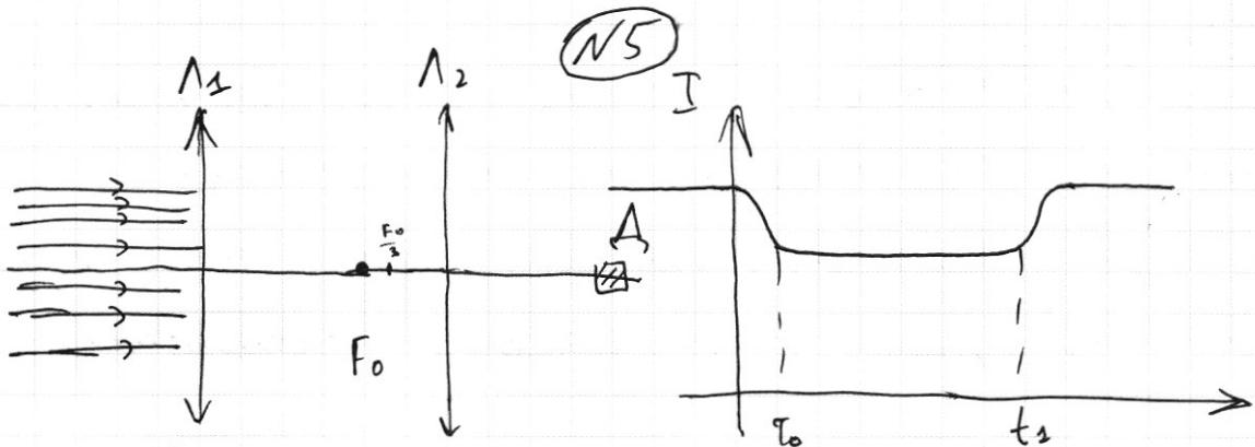
1) Приходящие лучи параллельны оптической оси линз  $L_1, L_2$ , значит они содержат в точке  $F_0$ , образуя „источник света“.
