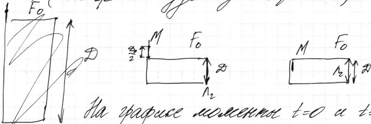
На графике моменты  $t=0$  и  $t=\tau_0$  соответствуют ~~тому~~ положению, когда  $M$  вне области и полностью в области света.  $M$  прошла расстояние  $\frac{D}{2}$  за  $\tau_0 \Rightarrow \boxed{V = \frac{D}{2\tau_0}}$  ( $V = \text{const}$ )
