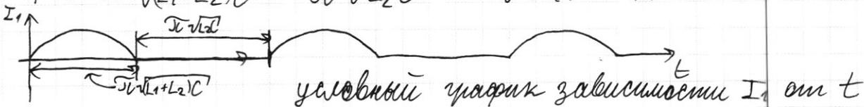
2) Ток через  $L_1$  максимален если ток через  $L_2$  максимален, а конденсатор заряжается  $\Rightarrow$  т.к.  $I_{M1}$ , то  $\dot{I}^* = 0 \Rightarrow L_1 \dot{I}^* + L_2 \dot{I}^* = 0 \Rightarrow U_c = E$
