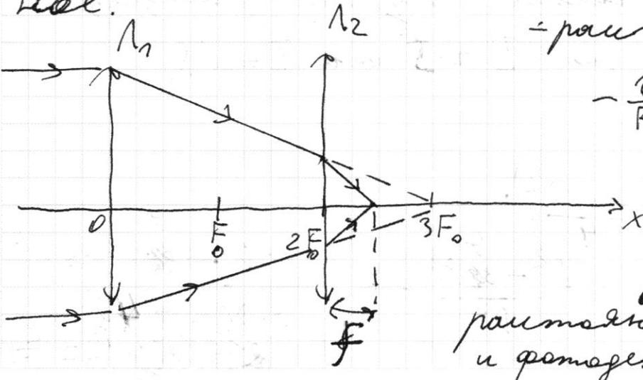
расстояние между линзой и фотоэлементом.
