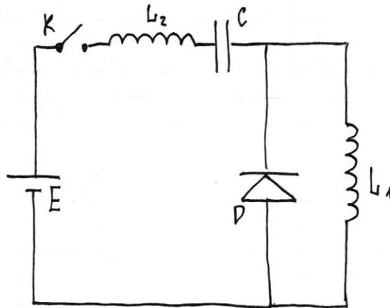
1) Изначально ток будет выходить из источника, т.к. конденсатор не будет заряжен. Отсюда найдем, что диод не будет пропускать ток.
