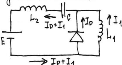
Так как напряжение, создаваемое на диоде током, равно нулю, то  $L_1 \frac{\Delta I_1}{\Delta t} = 0$ , а так как в момент, когда напряжение на конденсаторе максимально ток в цепи
