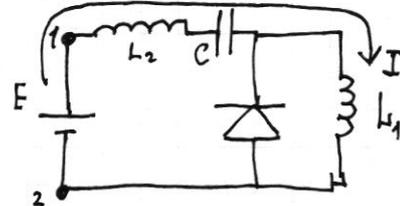
Когда напряжение на конденсаторе достигнет макс. значения, будет другая ситуация. Найдем время  $t_1$  зарядки конденсатора. Запишем уравнения из законов Кирхгофа, для нач. случая:
