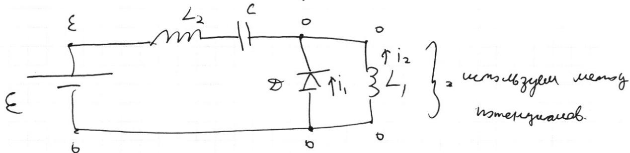
1) Т. к. дроссель идеальный, то напряжение открытия  $= 0$  и напряжение на дросселе  $= 0$ . Заменим, что разность потенциалов на катушке может  $= 0$ , то  $V_L = \frac{\Delta i}{\Delta t} = \frac{L(i_2 - i_L(0))}{\Delta t} = \frac{L i_2}{\Delta t}$  т.к.  $i_L(0) = 0$   $\Rightarrow \frac{L i_2}{\Delta t} = 0 \Rightarrow i_2 = 0$ . Тогда уравнение
