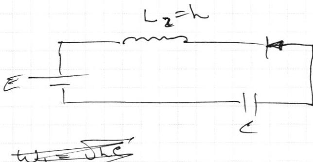
Анализ состояния ①  $T_2$  - период колебания этого состояния ( $E \parallel L \perp C$ ) равен  $T_2 = 2\pi \sqrt{Lc}$ , но когда один ток проходит через цепь, то он протекает через цепь
