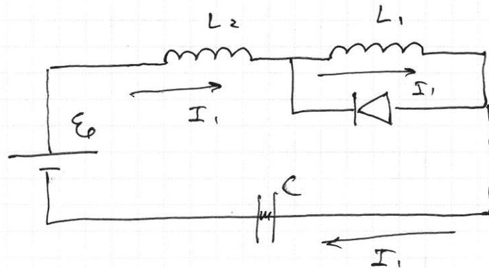
В самом начале ток не может течь против диода
