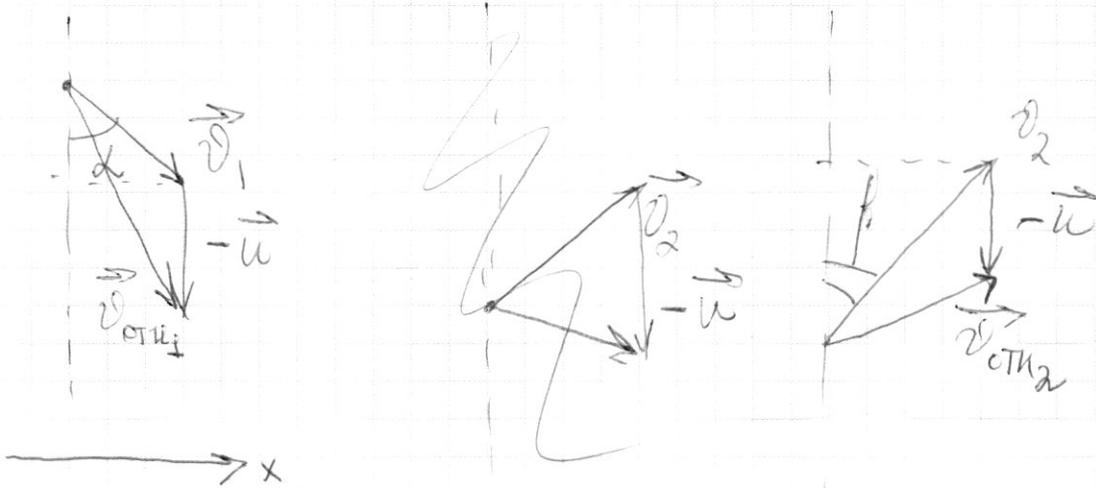
$$v_{отн1x} = v_1 \cdot \sin \alpha ; \quad v_{отн2x} = v_2 \cdot \sin \beta$$
