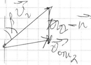
$$v_{\text{отн}1x} = v_1 \cdot \sin \alpha; \quad v_{\text{отн}2x} = v_2 \cdot \sin \beta$$
