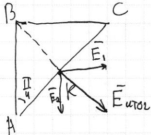
Т.к. треугольник симметричный, то напряжимости пластин АВ = напряжимости пластины ВС на оси симметрии, в которую входит точка К.  $\Rightarrow$  итоговая Е направлена как на рисунке ( $E_1 + E_2 = E_{\text{итог}}$ ) и  $6\sqrt{2}$  раз больше по модулю предыдущей.
