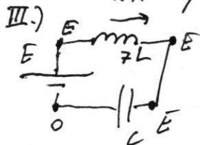
III) Катушки соединены последовательно  $\Rightarrow$  через них течет одинаковый ток. Рассмотрим момент, когда  $I_m = I = I_m$ , и  $U_L = 0$  и воспользуемся методом потенциалов:
