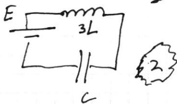
III) В контуре 1 и в контуре 2 направление тока меняется раз в пол периода, поэтому можно считать, что пока ток идет в одну сторону, проходит время  $\frac{1}{2}T_1$ , а пока в другую  $\frac{1}{2}T_2$ .
