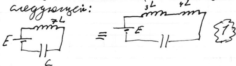
II) Если источник совершает отрицательную работу (  $\text{---} \text{---} \rightarrow \text{---} \text{---} \leftarrow \text{---} \text{---} \right.$  ), то схема эквивалентна следующей:
