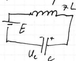
Напряжение на конденсаторе  $U_C$ :
