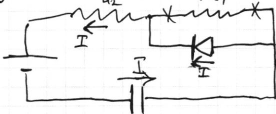
Напряжения на  $L_1$  равно 0, т.к. диод превращается в провод  $\Rightarrow 0 = LI \dot{I} \Rightarrow \dot{I} = 0$
