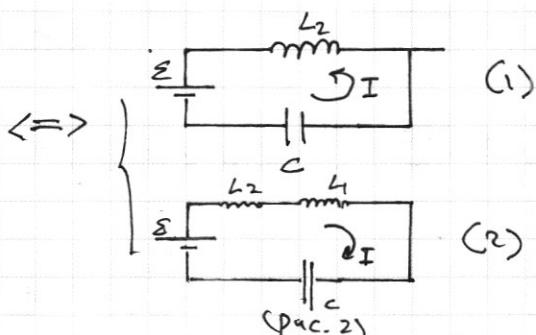
Представление на рис.1 схема эквивалентна двум схемам на рис.2 в зависимости от направление тока.
