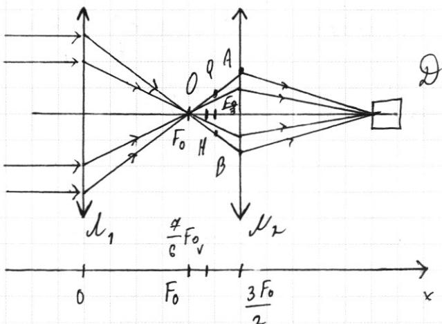
1) М. к. на  $L_1$  падает параллельный пучок света, он фокусируется в точке с коэффициентом  $F_0$ .
