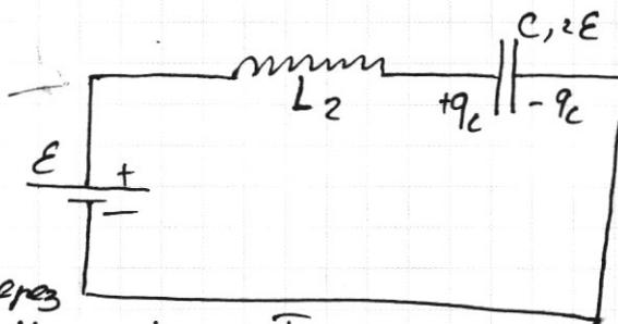
В момент максимального тока, текущего через катушку  $L_2$  напряжение на ней  $U_{L2} = L_2 \cdot \frac{\Delta I_2}{\Delta t} = 0$ .
