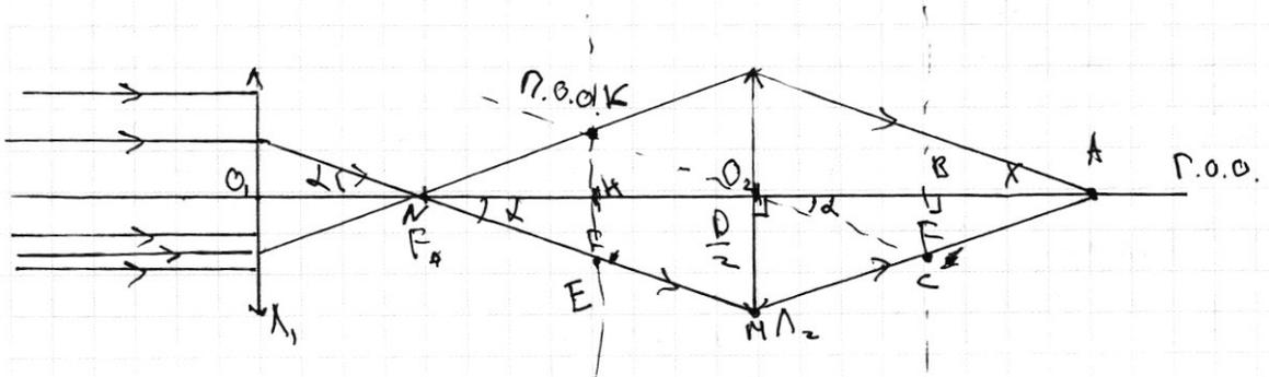
1) На рисунке показан ход луча идущего через край второго линза.  $\tan \alpha = \frac{D/2}{2F_0} = \frac{D}{4F_0}$  (т.к.  $O_2 F_0 = 0, O_2 - O_1 F_0 = 3F_0 - F_0 = 2F_0$ )
