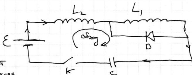
1) В таком случае ток будет течь через катушки последовательно, поэтому их можно заменить катушкой с  $L_{\text{общ}} = L_1 + L_2 = 3L$ .
