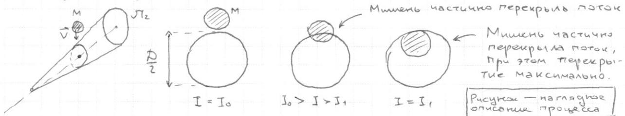
$$\text{Или. Энергия света } \sim S, \text{ то } \frac{S_{\text{сеч}} - S_m}{S_{\text{сеч}}} = \frac{I_1}{I_0} = \frac{3}{4} \quad (*)$$
