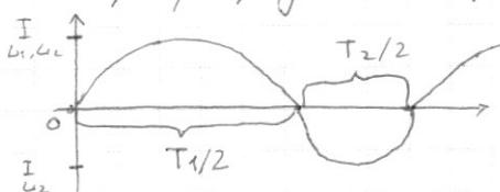
$$T = \frac{T_1}{2} + \frac{T_2}{2} = \pi\sqrt{LC} (1 + \sqrt{3}) - \text{общий период колебаний.}$$
