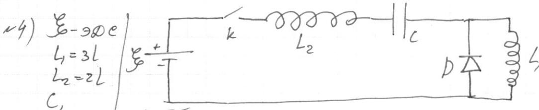
1) Начиная на конденсаторе, начинай зарядку по функции  $q(t)$ , тогда  $I = \frac{dq(t)}{dt} = \dot{q}(t)$ , а  $\ddot{I}(t) = \ddot{q}(t)$  пока конденсатор заряжается должно быть суперпозиционное равенство:  $\ddot{E} = U_{L_1} + U_C + U_L$  (так через диагноз не идёт)
