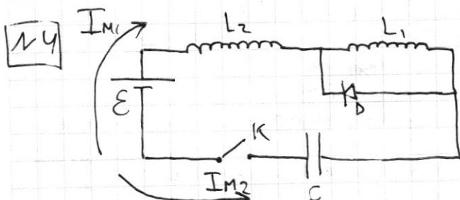
$$① T_{качания LC} \text{ цепочки} = 2\pi \sqrt{LC}.$$
