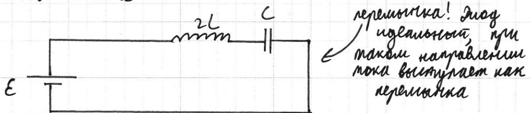
с полупериодом  $t_2 = \frac{1}{\pi} \sqrt{2LC}$ . Итоговый период колебаний  $T = t_1 + t_2 = \frac{1}{\pi} \sqrt{LC} (\sqrt{2} + \sqrt{5})$ .
