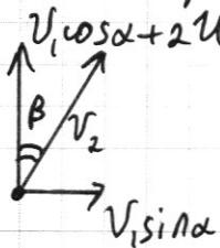
$$v_2^2 = (v_1 \cos \alpha + 2u)^2 + (v_1 \sin \alpha)^2, \text{ т. к. } v_2 = \sqrt{v_1^2 + 2u^2}, \text{ имеем}$$
