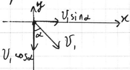
перпендикулярна  $\vec{v}_x$ , столкновение не изменит скорость по этой оси:  $v_x = v_{x\text{новая}}$ , откуда  $v_2 = v_1 \frac{\sin \alpha}{\sin \beta} = 2v_1 = 12 \text{ м/с.}$
