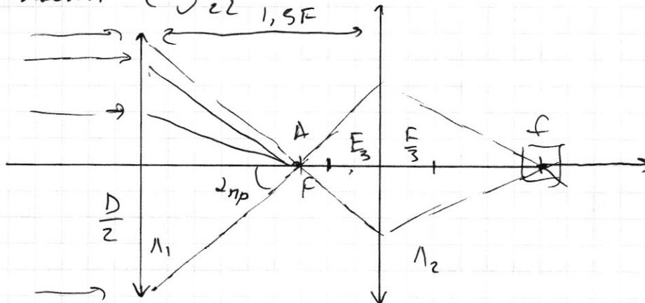
1) Лучи проходя через первую линзу проходят через ее фокус, чтобы после этого лучи проходили через вторую линзу попадали в одну точку на главной оси, а такая точка будет одна, это изображение точки A в линзе  $L_2$ ;  $\frac{1}{0,5F} + \frac{1}{F} = \frac{1}{F_3} \Leftrightarrow \frac{2}{F} + \frac{1}{F} = \frac{3}{F} \Rightarrow F = F_3$ .
