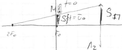
За  $T_0$  линза „захватила“ на всю свою длину  $\rightarrow T_0 = \frac{D}{V} \rightarrow V = \frac{D}{2T_0}$
