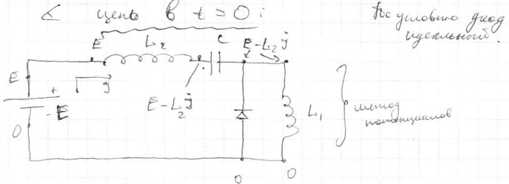
$U_{\phi} = E - L_2 \dot{j}$  - напряжение на диоде
