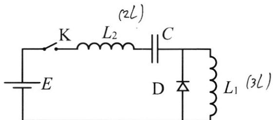
4. Электрическая цепь собрана из идеальных элементов: источника с ЭДС  $E$ , катушек с индуктивностями  $L_1 = 3L$ ,  $L_2 = 2L$ , конденсатора емкостью  $C$ , диода D (см. рис.). Ключ K разомкнут, конденсатор не заряжен, тока в цепи нет. После замыкания ключа возникают колебания тока в  $L_2$ .
