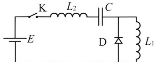
4. Электрическая цепь собрана из идеальных элементов: источника с ЭДС  $E$ , катушек с индуктивностями  $L_1 = 3L$ ,  $L_2 = 2L$ , конденсатора емкостью  $C$ , диода  $D$  (см. рис.). Ключ  $K$  разомкнут, конденсатор не заряжен, тока в цепи нет. После замыкания ключа возникают колебания тока в  $L_2$ .
