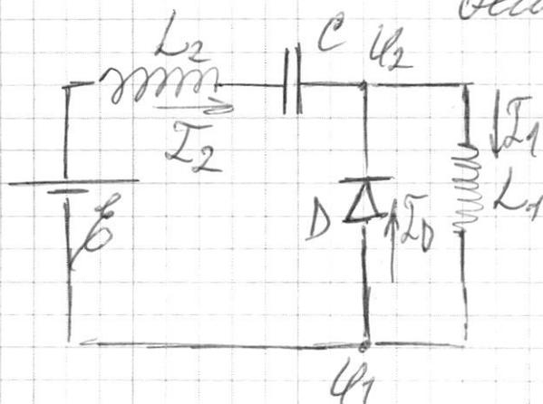
1) Рассмотрим процесс зарядки конденсатора (при этом  $I_D = 0$ ):
