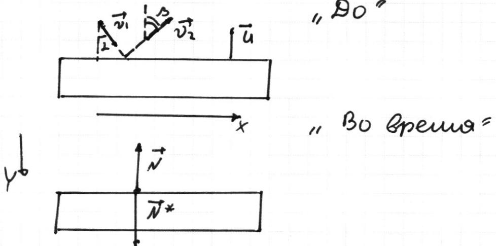
1) Рассмотрим систему „шарик + пистолет“. Считай генич. за малое время можно пренебречь по  $v_{sh}$   $\Rightarrow$  верен ЗСИ  $ox$ :  $m v_1 \sin \alpha = m v_2 \sin \beta$
