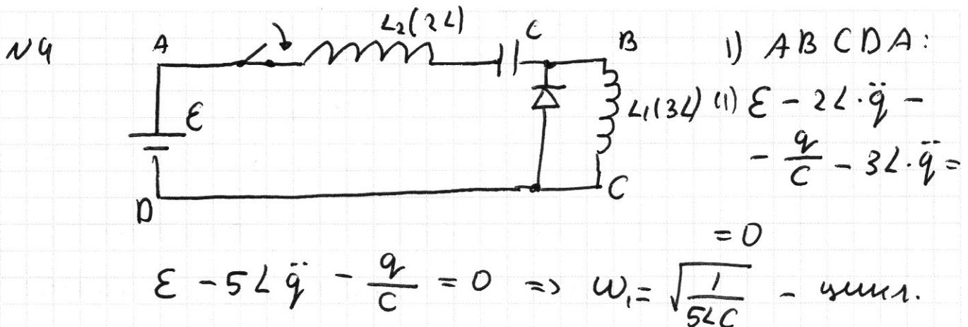
частота 1 комм. контура. Ток идет через  $L_1$  т.к  $D$ -запрыг. После того, как конд. зарядится до  $q = CE$   $\dot{q}^*$ .
