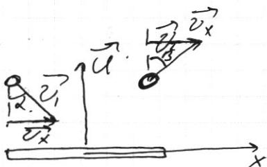
Т.к. массивная тиба движется с постоянной скоростью в горизонтальном направлении  $\rightarrow$  изменение скорости шарика во время удара происходит только в вертикальной плоскости, но не в горизонтальной
