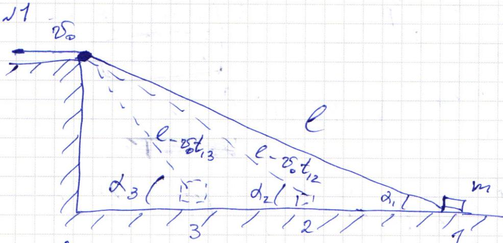
1) Если горизонтальная часть ледокла за время  $at$  увеличила свою длину на  $\Delta x = 25 \cdot at$ , то наклонная часть ледокла увеличила свою длину  $\Rightarrow$  на  $\Delta x$ , груз за такое время  $at$  пролезжал на  $\Delta y = 25 \cdot at$ , причем  $\Delta y = \frac{\Delta x}{\cos \alpha}$ , откуда скорость груза  $v_2 = \frac{v_0}{\cos \alpha} = \frac{v_0}{\sqrt{1 - \frac{1}{9}}} = \frac{3v_0}{\sqrt{5}}$
