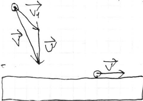
условие нулевой  $\Rightarrow$  изменение импульса шарика  $|\Delta p| = m \cdot (v + v_1 \cos \alpha)$  и конечная скорость горизонтальная,
