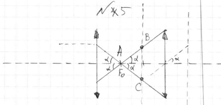
Все лучи, попавшие в  $L_1$ , пройдут через её фокус. На  $L_2$  из них попадут, а имеющие угол  $\alpha$  и меньше с горизонтом (сл. опт. осью) при преломлении (см. рис.).  $\operatorname{tg} \alpha = \frac{D}{2F_0} = \frac{D}{4F_0}$ .
