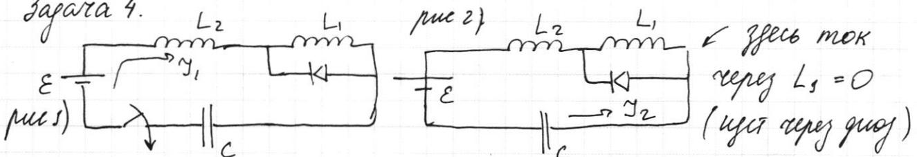
1) После замыкания, т.к.  $U_{C0} = 0 \Rightarrow$  ток по часовой стрелке (рис 1)
