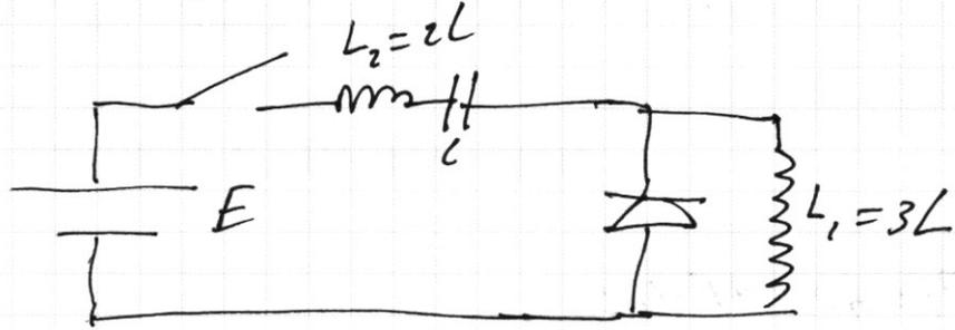
1) ПЕРИОД  $T$  - ПОЛУСУММА ПЕРИОДОВ ЦЕПЕЙ, ~~С~~ С КОНДЕНСАТОРОМ  $C$ , КАТУШКОЙ  $L_2$  И С КОНДЕНСАТОРОМ  $C$ , КАТУШКОЙ  $L_1 + L_2$  (ПЕРВОЕ) (В ОДНО ПОЛУКОЛЕБАНИЕ
