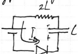
на катушке будет неизменен, а в момент открытия диода ток ветви станет равен нулю, значит токи он на катушке и останутся
