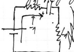
Последовательно подключенные катушки можно заменить на одну.
