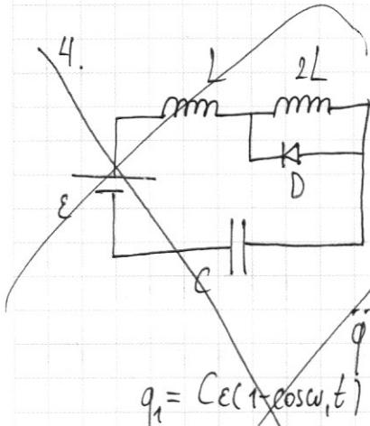
1) В начале колебательного процесса дуга закрыта, т.к. ток сквозь неё идёт против хода. Уравнение колебаний при закрытой дуге:
