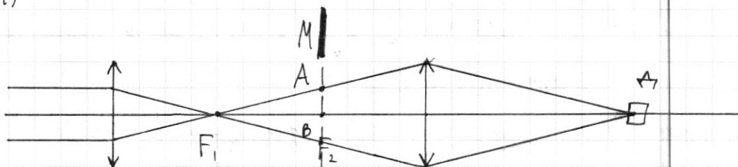
Параллельный пучок света фокусируется первой линзой в своём фокусе  $F_1$ . Понужем точечный источник на расстоянии  $2F_0$  от второй линзы. По формуле тонкой линзы:  $\frac{1}{2F_0} + \frac{1}{f} = \frac{1}{F_0}$ , отсюда  $f = 2F_0 \Rightarrow$  фотодетектор находится на расстоянии  $2F_0$  справа от  $L_2$ .
