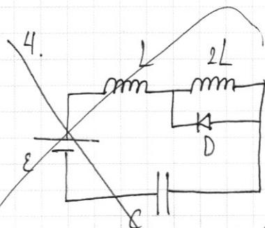
1) В начале колебательного процесса диод закрыт, т.к. ток сначала течёт против него. Уравнение колебаний при
