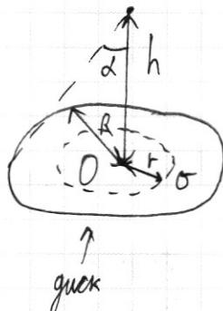
$\alpha$  - телесный угол, под которым видна поверхность.
