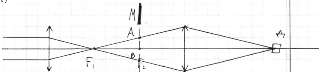
Параллельный пучок света фокусируется первой линзой в своём фокусе  $F_1$ . Поставим точечный источник на расстоянии  $2F_0$  от второй линзы. По формуле тонкой линзы:  $\frac{1}{2F_0} + \frac{1}{f} = \frac{1}{F_0}$ , откуда  $f = 2F_0 \Rightarrow$  фотодетектор находится на расстоянии  $2F_0$  справа от  $L_2$ .
