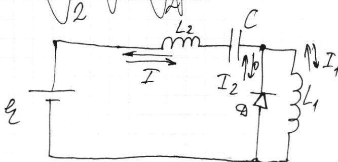
$$\frac{1}{2C} dq + \frac{L_1 + L_2}{2} dq'' = \frac{dI}{dt} + (L_1 + L_2) dq''$$
