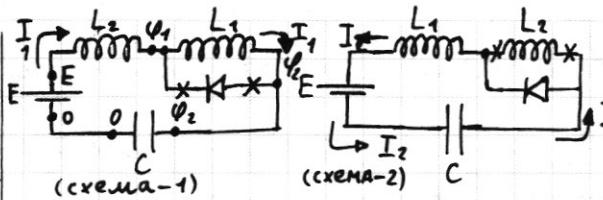
1) Когда ток течёт по часовой стрелке диод закрыт и весь ток
