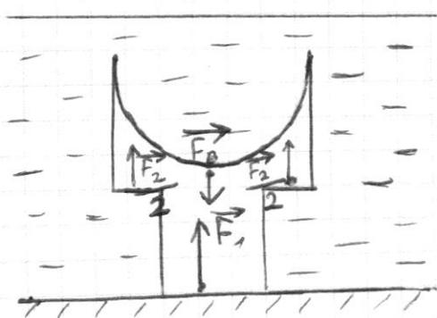
Теперь запишем чему равна сила Архимеда, действующая на конструкцию без клея, с которой мы пока что работаем, и отсюда выразим  $F_2$  через  $F_0$ , учитывая,
