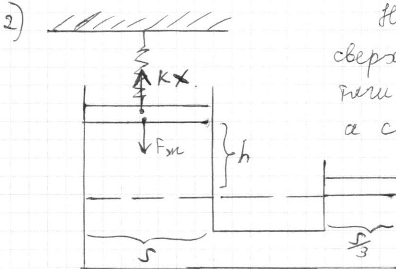
На левый поршень сверху действует сила пружины, равная  $kx$ , а снизу „сила тяжести“ жидкости  $F_m$ .
