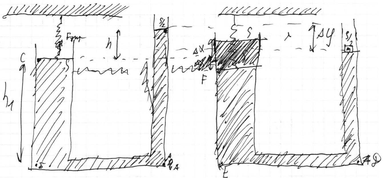
$$P_A = pg(h + h_1) = P_B - \text{давление в } A \text{ и } T. \delta$$
