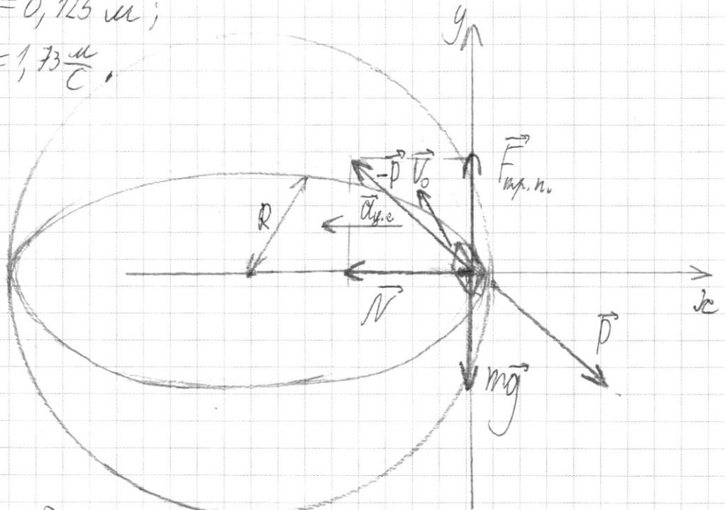
На <sup>модель</sup> автомобиль действуют силы тяжести  $mg$  и сила со стороны земли  $-p$ , равная векторной сумме сил  $F_{тр.н.}$  и  $N$  и силы трения покоя  $F_{тр.п.}$  направленной вертикально вверх, т.к. модель может начать <sup>маленько</sup> проскальзывать  $\checkmark$  перпендикулярно направлению движения  $V_0$  в данный момент.
