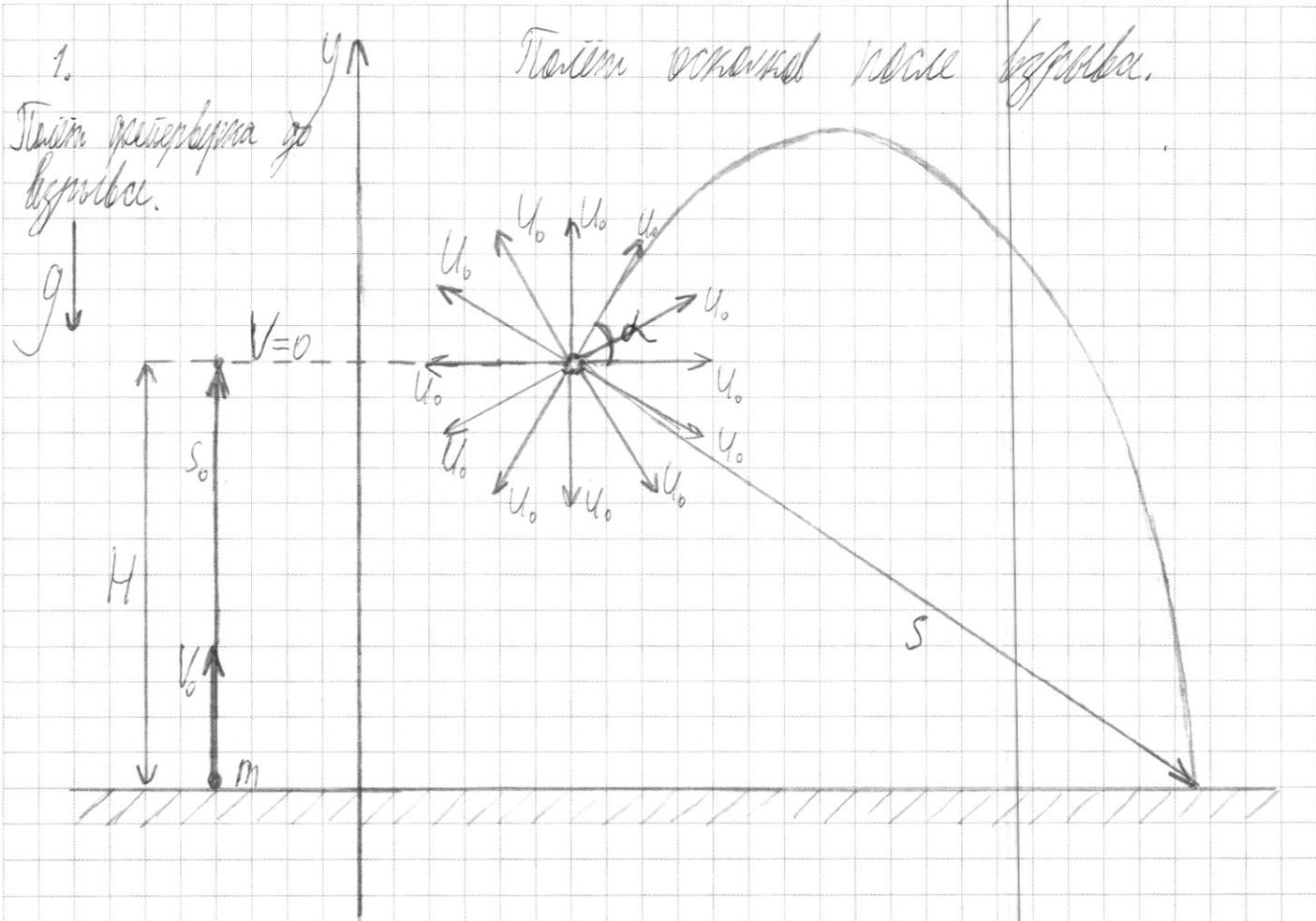
В высшей точке траектории скорость прелетевшего  $\vec{V} = \vec{0}$ . Путь от начала до старта до взрыва равно  $S_0$ . Введём ось  $y$ , направленную вертикально вверх. На прелетевшем во время полета действует только сила тяжести  $m\vec{g}$ , значит его движение по II закону Ньютона равно  $\vec{g}$ , т.е. движение равноускоренное.
