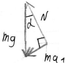
$$N = mg \cos \alpha \quad \text{направим ось } z \text{ вдоль пов. клина}$$
