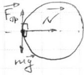
$$a = \frac{N}{m} = \frac{2mg}{m} = 2g = 20 \text{ (м/с}^2\text{)} \quad \left( \begin{array}{l} \text{2ой закон} \\ \text{Ньютона} \end{array} \right)$$
