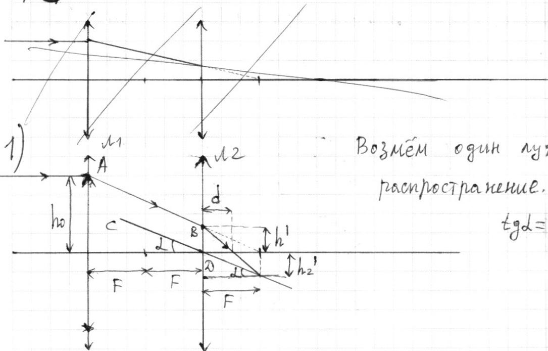
Возмём один луч и рассмотрим его распространение. Дуги AB || CD
