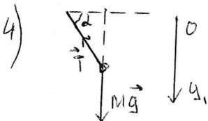
Вдоль вертикальной оси  $Oy_1$  на II з.н.:  $m a_y = mg - T \cdot \sin \alpha$
