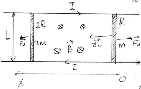
В начале скорость правой перемычки ( $v_1$ ) будет больше скорости левой перемычки ( $v_2$ ), поэтому площадь контура, пронизываемого магнитным полем, уменьшится.
