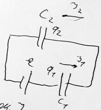
Потому если через 1 конденсатор течет ток  $j_0$ , то через другой должен течь ток  $2j_0$  в том же направлении. В соотв. с 1 правилом Кирхгофа  $j_{к.} = j_1 + j_2 = j_0 + 2j_0 = 3j_0$
