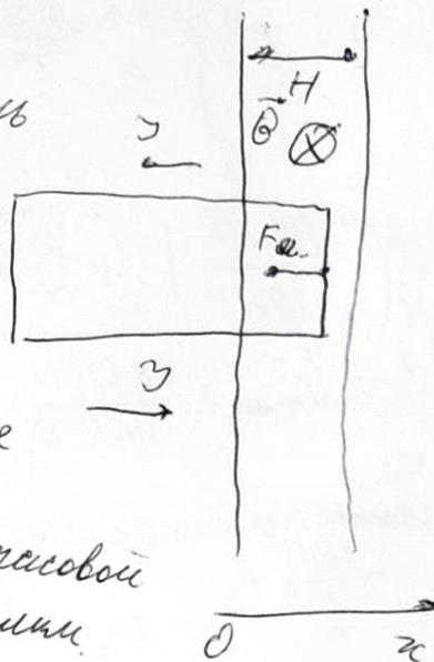
$$\frac{d\Phi}{dt} = B \frac{dS}{dt} = B v d \text{ и напр. против часовой стрелки.}$$
