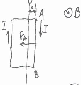
При этом внаг в ускорение будет давать только сила Ампера, действ. на сторону AB, (на другие стороны поле или не действует или действие сокращено)
