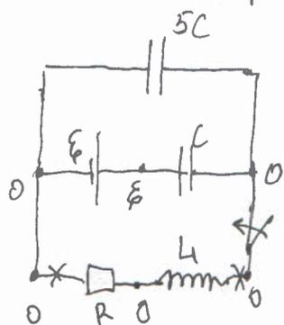
Уст. режим  $\Rightarrow$  ток через конденсер не течет, на катушке постоянный ток и напряжение  $= 0$
