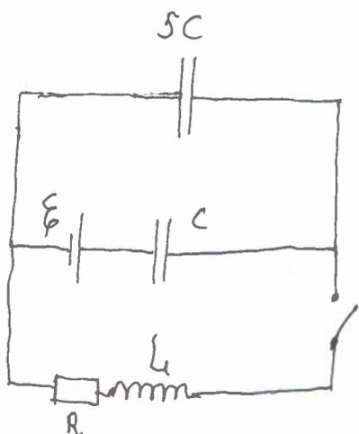
1) Рассмотрим цепь до замыкания ключа. Решим установившаяся  $\Rightarrow$  конденсеры зарядятся, ток через них не течет.
