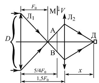
$$3) \text{ Интервал от начала входа в конус до начала выхода из конуса } t_1 = \frac{D_1}{V} = 3\tau_0$$
